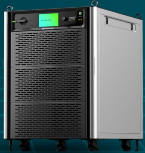
RPS-5000 再生電源系統提供 30 kVA 至 225 kVA 的高效能電力，整合了交流/直流電源、電子負載與電網模擬器於一體。憑藉先進的波形諧波分析與模擬功能，確保精確、高效且穩定的電力測試。此系統專為 AI 伺服器電源、新能源、電動車（EV）及電力電子領域設計，不僅符合 IEC 61000 法規要求，更透過雙向再生設計提升測試靈活度與能源使用效益。
