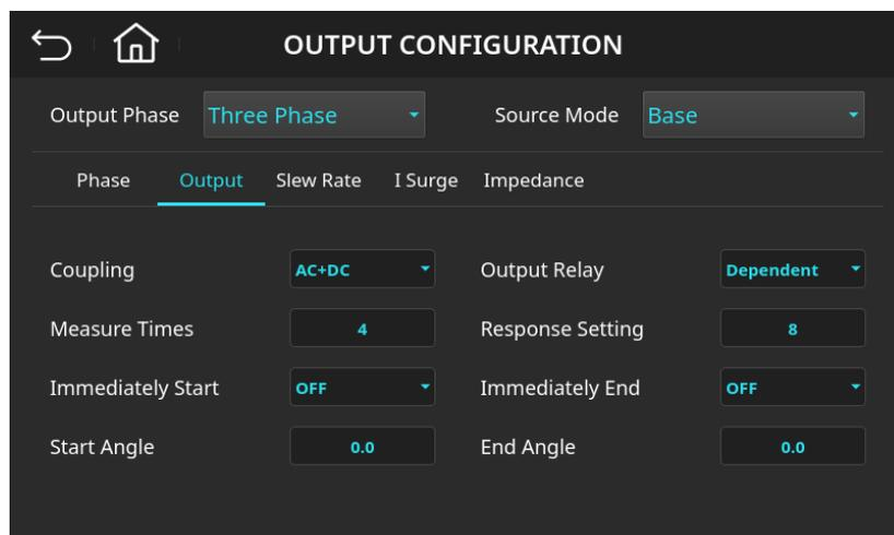
圖 4-38 輸出配置(Output)頁面(Measure Times 設定為 4)
