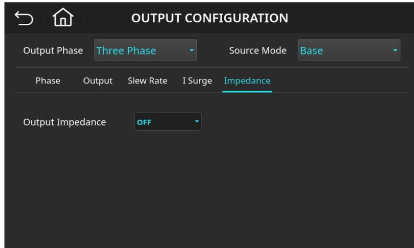
圖 4-46 可程式設計輸出阻抗功能 (Impedance) 頁面
