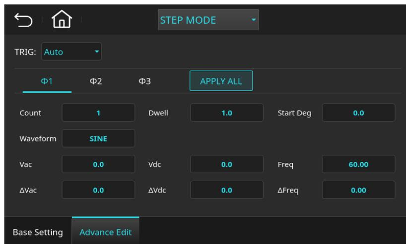
圖 5-13 步階模式(Step)設定頁面
