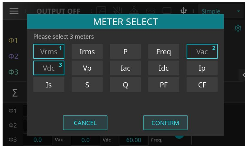
圖 4-12 選取量測參數 "Vac"、"Vdc" 頁面
