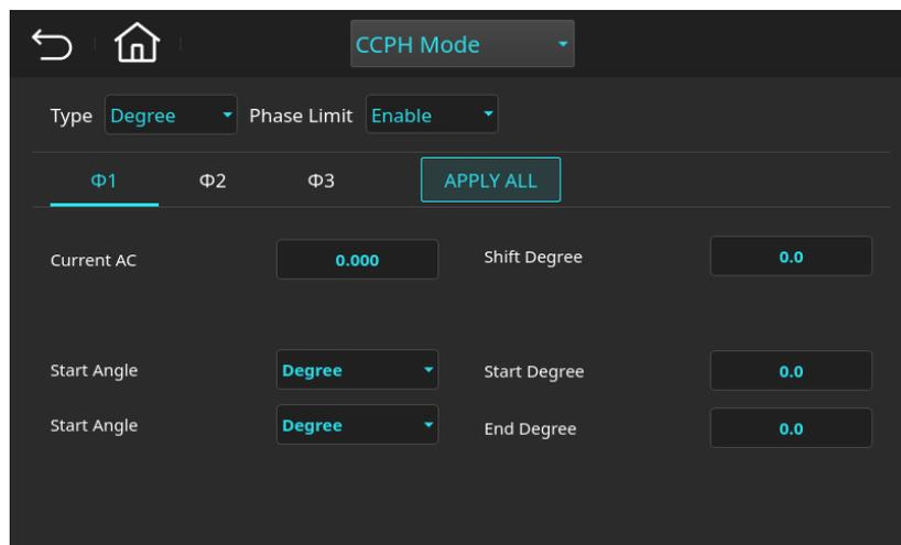
圖 9-7 定電流相位移模式(CCPH Mode)頁面
