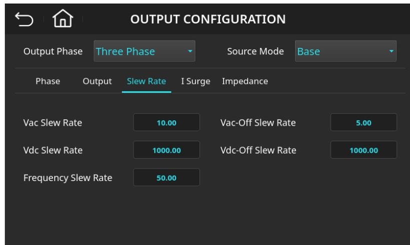
圖 4-42 輸出變化率(Slew Rate)設定頁面
