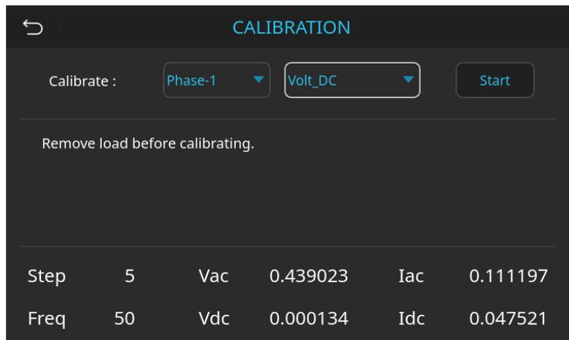
圖 8-11 校準第一相的輸出直流電壓畫面
