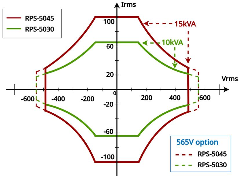
圖 1-2 直流電壓/電流操作範圍圖-三相模式
