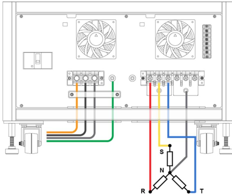
圖 3-2 輸出電源線接線方式
