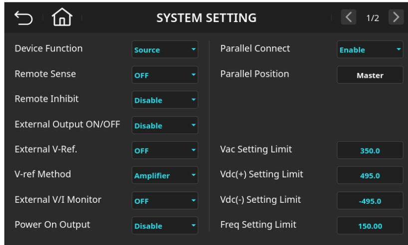
圖 6-10 系統功能設定頁面(Parallel Connect=Enable)
