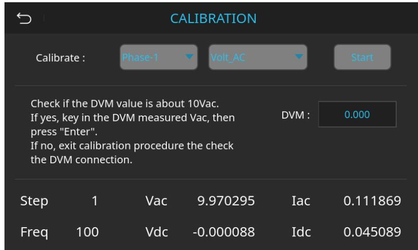
圖 8-15 校準輸出交流電壓程式-輸出 10Vac
