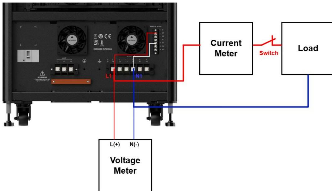
圖 8-1 校準設備接線(L1/N1)示意圖
