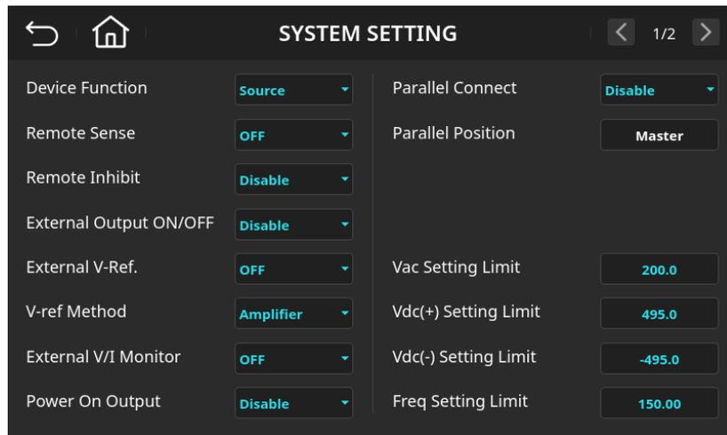
圖 6-12 系統功能設定頁面(Vac Setting Limit=200.0)
