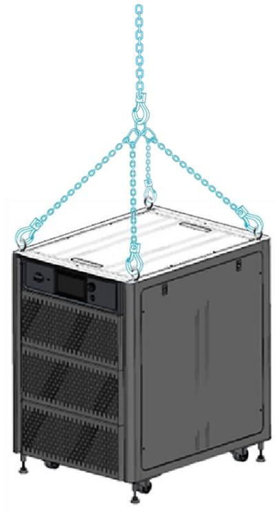
圖 2-2 具四角吊鉤吊車搬運方式示意圖
