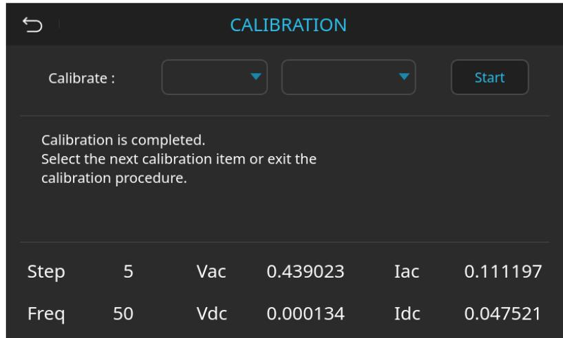
圖 8-10 輸出電壓偏移校準完成畫面
