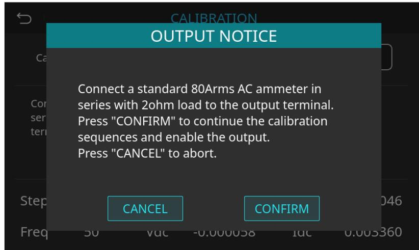
圖 8-21 校準輸出交流電流程式的通知畫面
