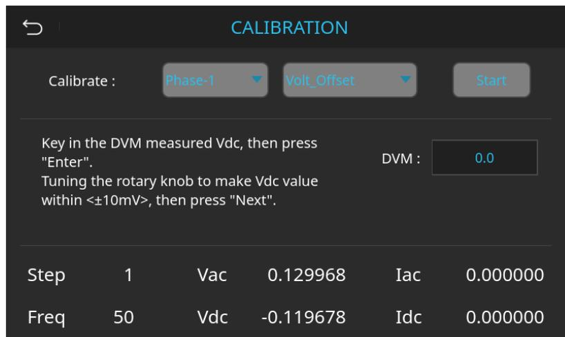
圖 8-7 校準輸出偏移電壓程式
