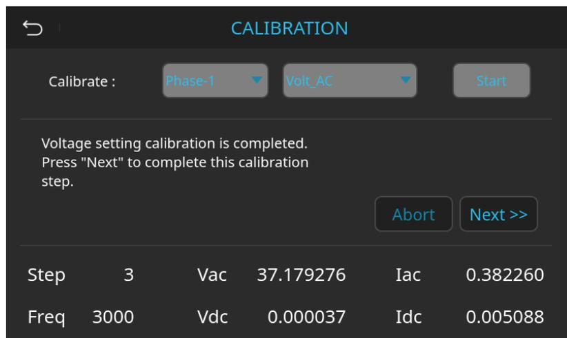
圖 8-17 輸出交流電壓校準完成畫面
