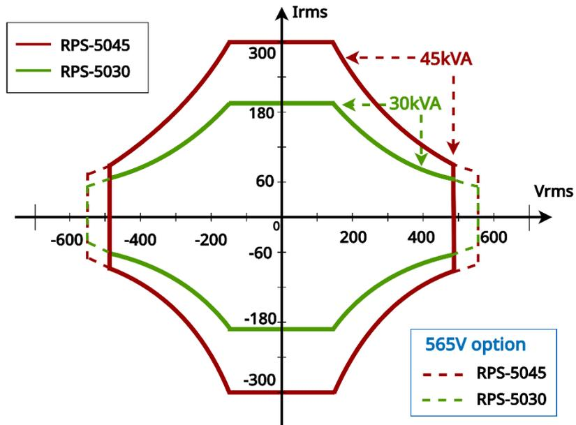
圖 1-4 直流電壓/電流操作範圍圖-單相模式
