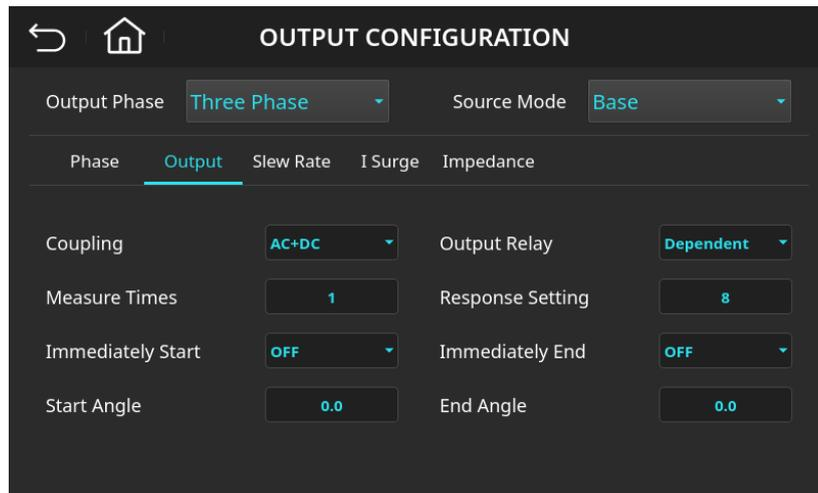
圖 4-35 輸出配置(Output)設定頁面
