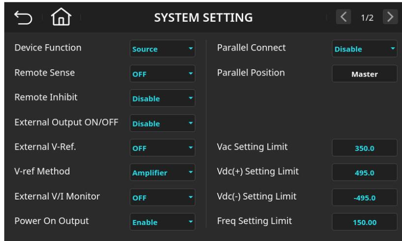
圖 6-9 系統功能設定頁面(Power On Output=Enable)
