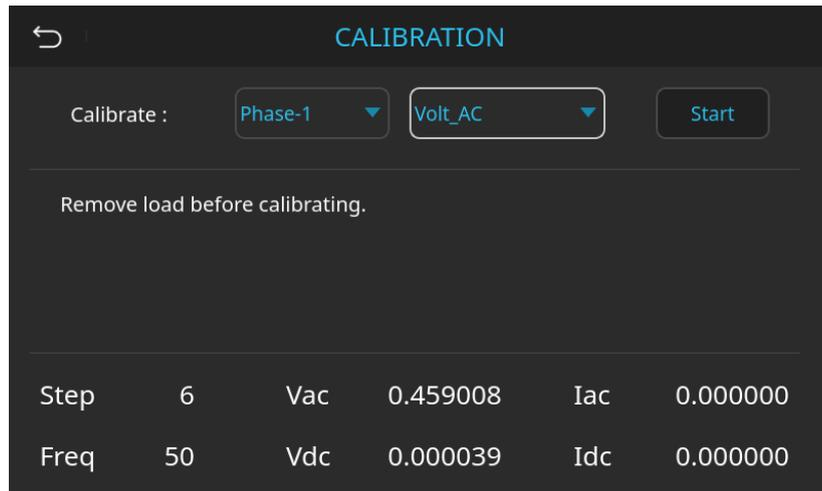
圖 8-14 校準第一相的輸出交流電壓畫面
