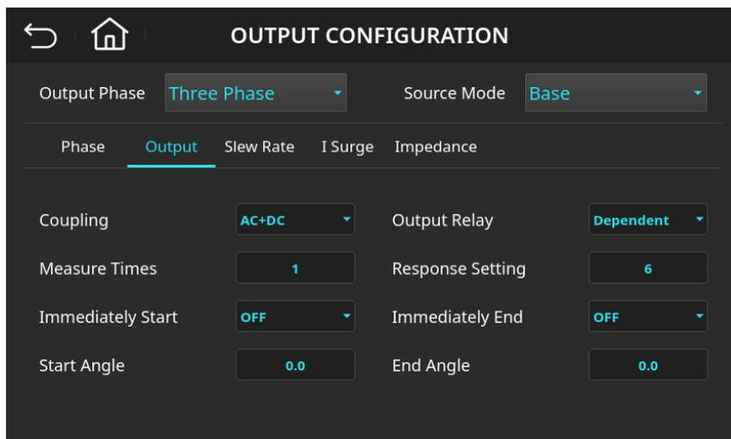
圖 4-39 輸出配置(Output)頁面(Response Setting 設定為 6)
