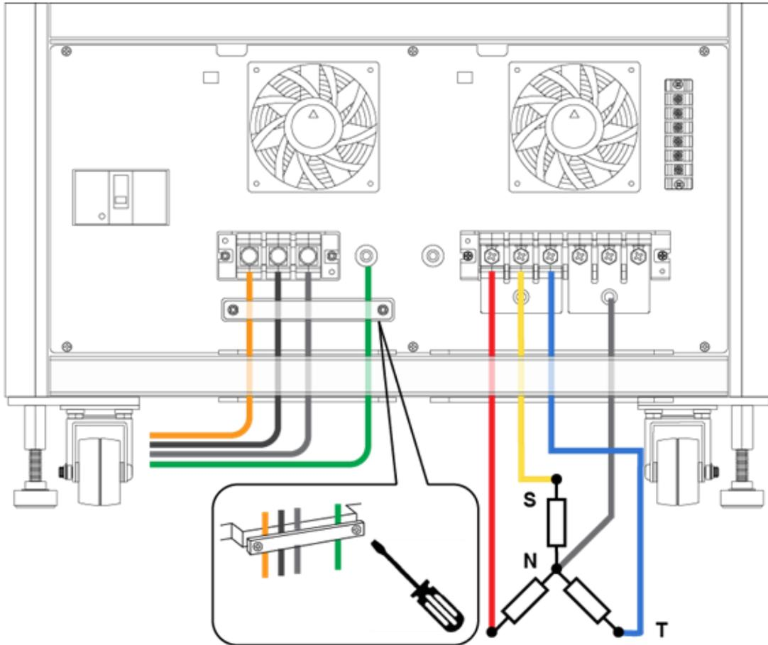
圖 3-1 輸入三相電源線接法及固定接線方式
