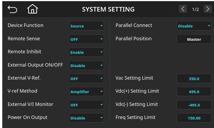
圖 6-4 系統功能設定頁面(Remote Inhibit=Enable)
