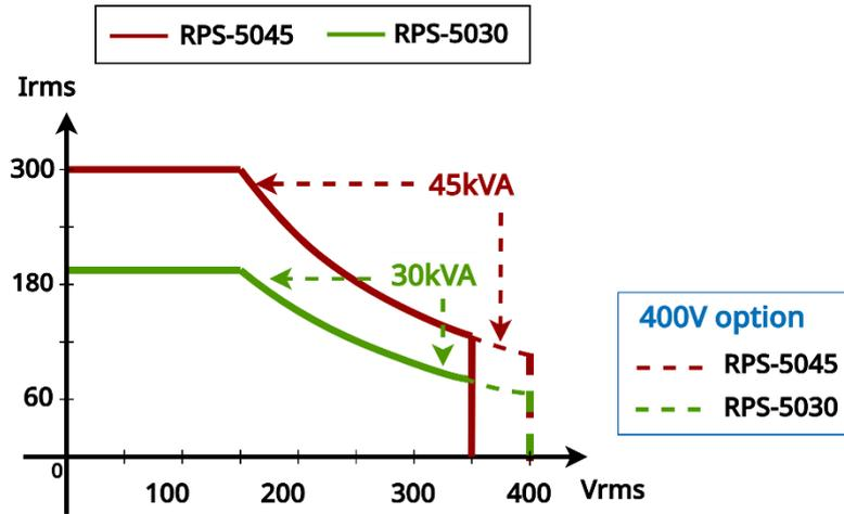
圖 1-3 交流電壓/電流操作範圍圖-單相模式
