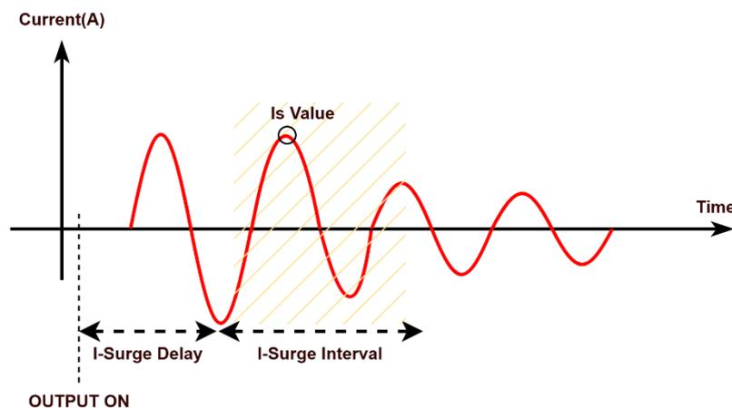
圖 4-44 輸出突波電流量測動作示意圖
