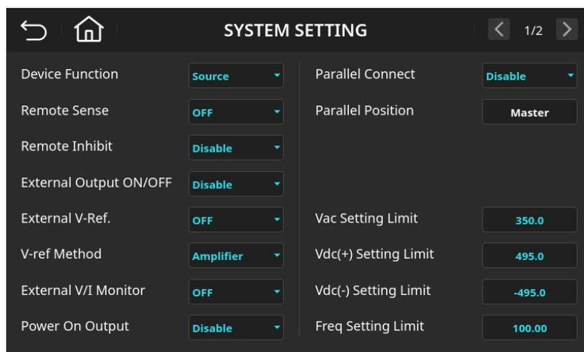
圖 6-14 系統功能設定頁面(Freq Setting Limit=100.00)
