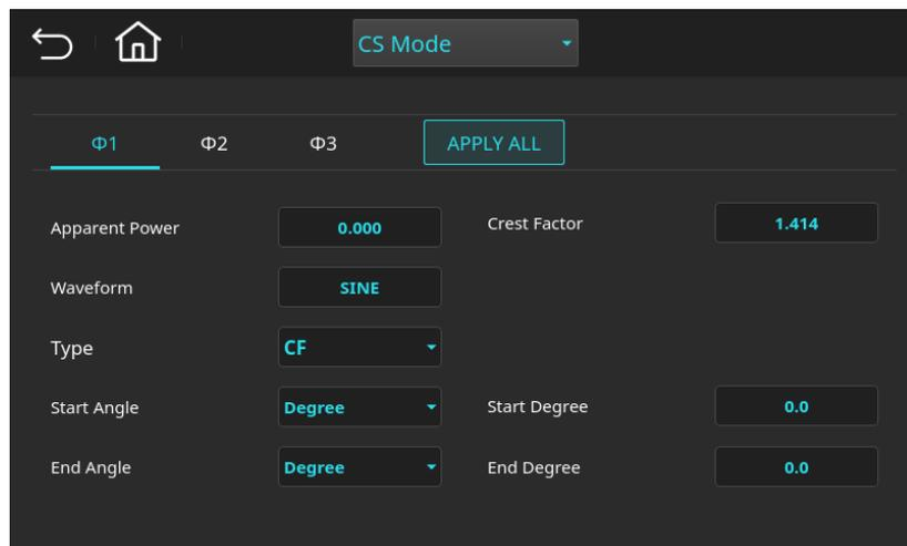
圖 9-4 定視在功率操作模式(CS Mode)頁面
