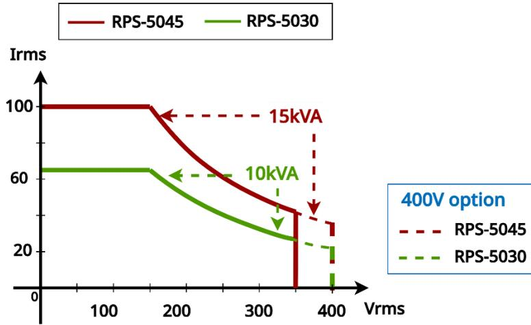
圖 1-1 交流電壓/電流操作範圍圖-三相模式
