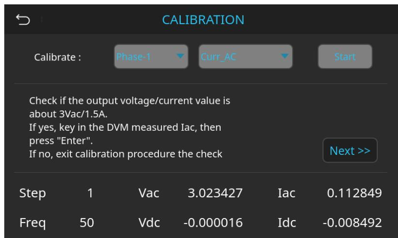
圖 8-22 校準輸出交流電流程式-輸出 3Vac
