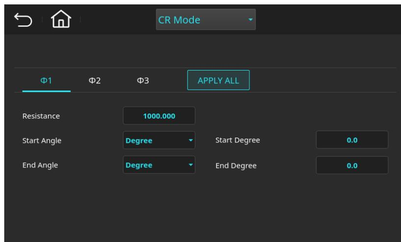
圖 9-5 定電阻操作模式(CR Mode)頁面
