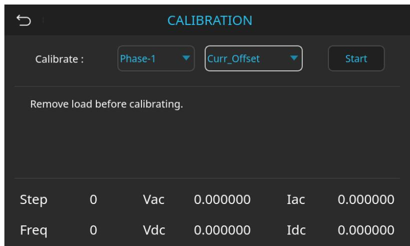
圖 8-18 校準輸出偏移電流程式
