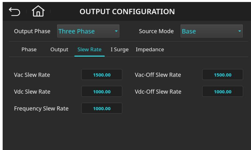
圖 4-41 輸出變化率(Slew Rate)設定頁面
