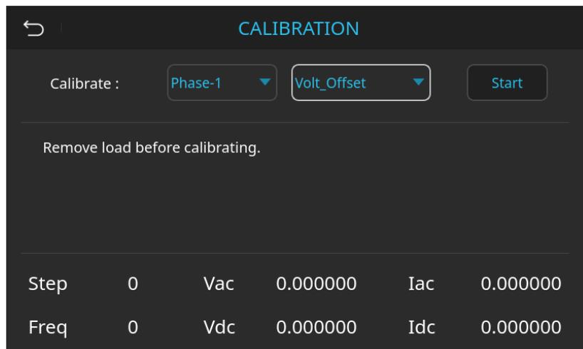
圖 8-5 校準第一相的輸出偏移電壓畫面
