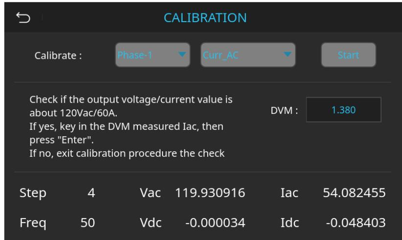
圖 8-23 校準輸出交流電流程式-輸出 120Vac
