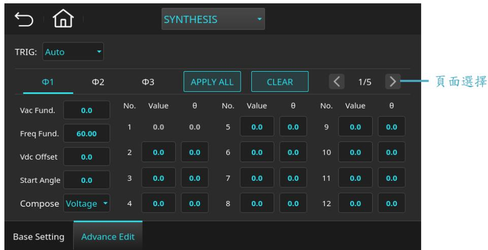
圖 5-24 波形合成模式(Synthesis)設定頁面
