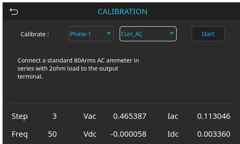
圖 8-20 校準第一相的輸出交流電流畫面
