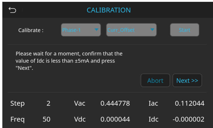
圖 8-19 校準輸出偏移電流程式-確認 Idc 讀值
